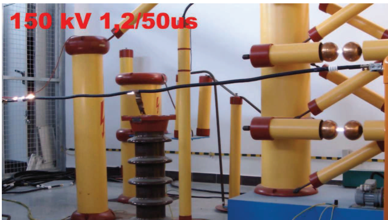
Rys. 6. Próbkę nr 1 podczas zadziałania generatora przy U_p=100\text{ kV } 1,2/50\text{ }\mu\text{s}
