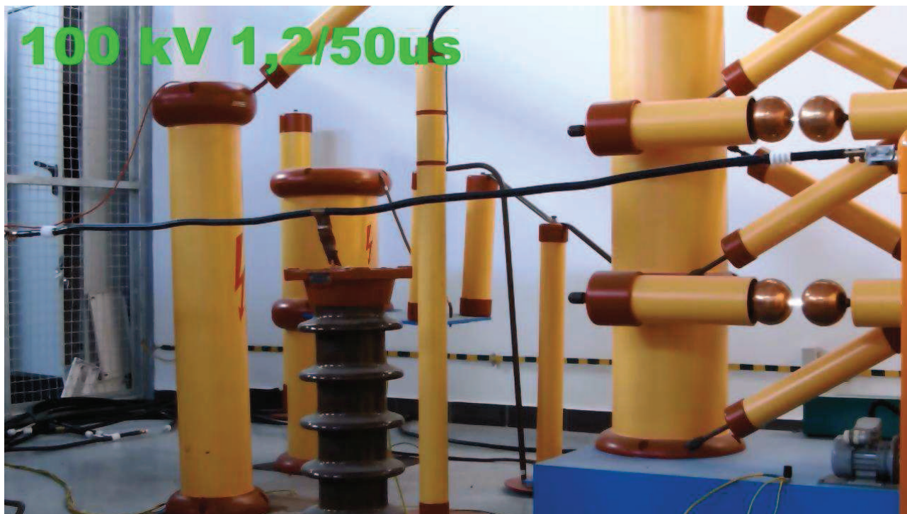
Rys. 6. Próbkę nr 1 podczas zadziałania generatora przy U_p=100\text{ kV } 1,2/50\text{ }\mu\text{s}
