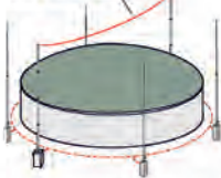
Ochrona obiektu z wykorzystaniem masztów AH070001W w układzie z masztami wolnostojącymi
